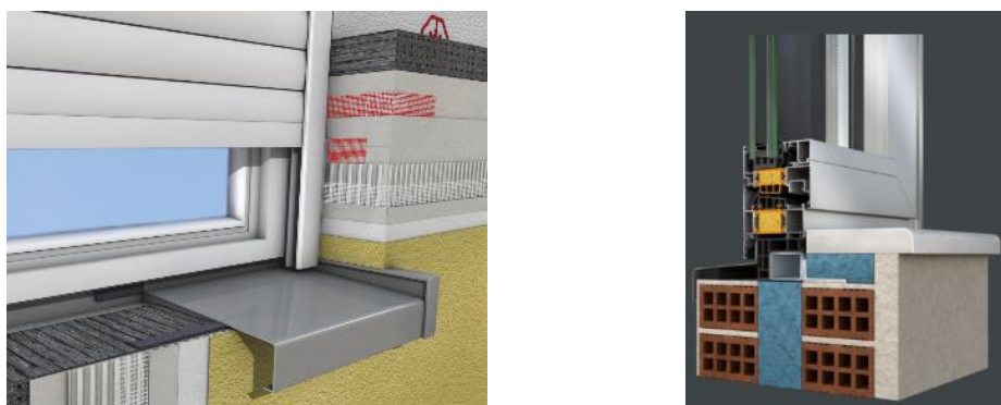
Σχήμα 3.10: «Κτίσιμο» του κατωκασίου μετά την τοποθέτηση του κουφώματος.
