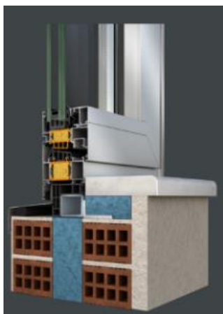
Εικόνα 4.4: Ορθές πρακτικές μόνωσης / στεγάνωσης
